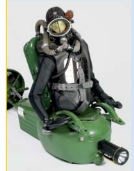
U-Boot des KGB zur Anbringung von Spreng- ladungen an Schiffen
